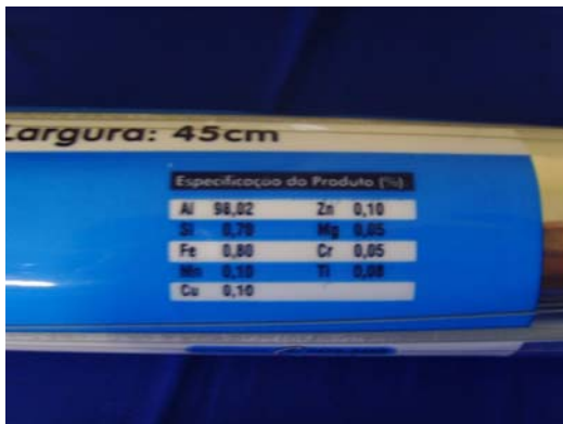
(2) Chemical characteristics Al 98.02%; Fe 0.80%; Si 0.70%; Mn 0.10%; Cu 0.10%; Zn 0.10%; Ti 0.08%; Mg 0.05%; Cr 0.05%.
